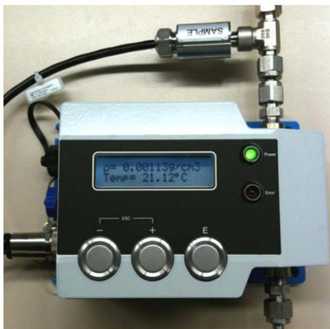
Abbildung 1: der neue Sensor „NanoMass“
