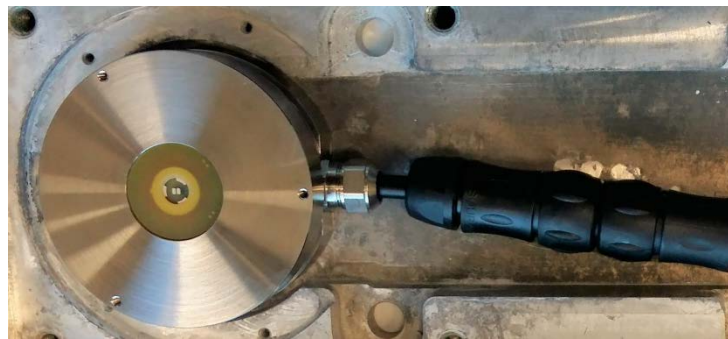
Abb. 3: IT-Artis in einem offenen Flughafenwechselgehäuse (Messsonde zur Bestimmung der Gefrierpunkte)
